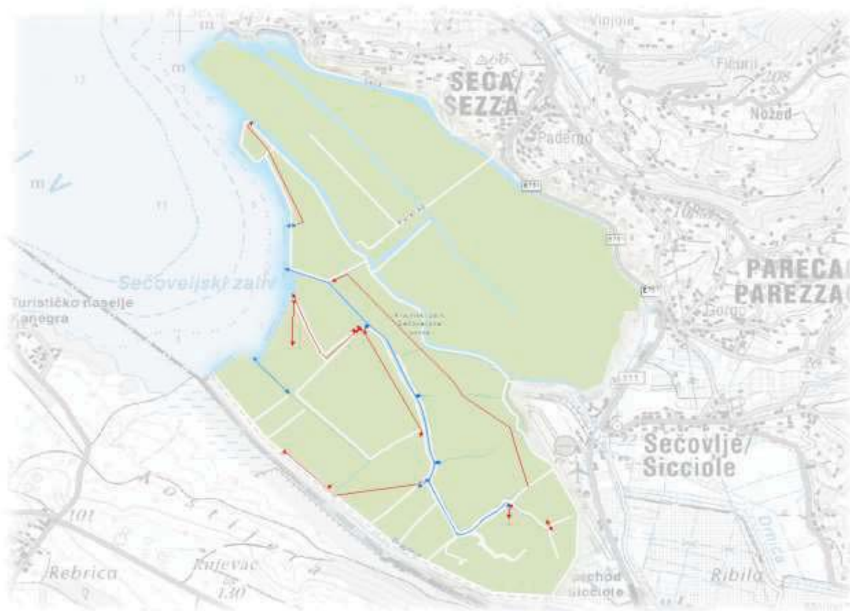
SLIKA 7. SHEMATIČNI PRIKAZ NALIVANJA OZIROMA PREMIKANJA VODE NA OBMOČJU FONTANIGGE. Z MODRO JE OZNAČENO NALIVANJE MORSKE VODE IZ NALIVNIH KANALOV PREK ZAPORNIČNIH SISTEMOV (KALIJEV) V BAZENE, Z RDEČO PA PREMIK VODE MED POSAMEZNIMI BAZENI Z NAMENOM ZAGOTAVLJANJA USTREZNEGA NIVOJA VODE, KI GA ODČITAVAMO S POMOČJO MERSKIH LAT.
