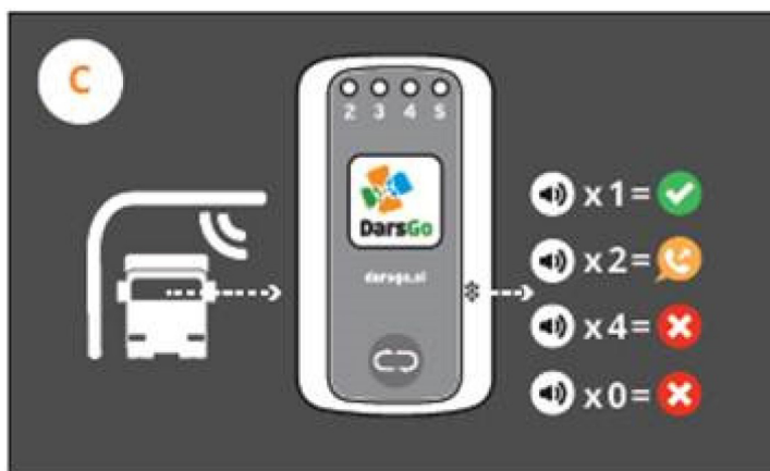
Slika 3: Signali naprave DarsGo ob vožnjah vozil skozi točke cestninjenja
